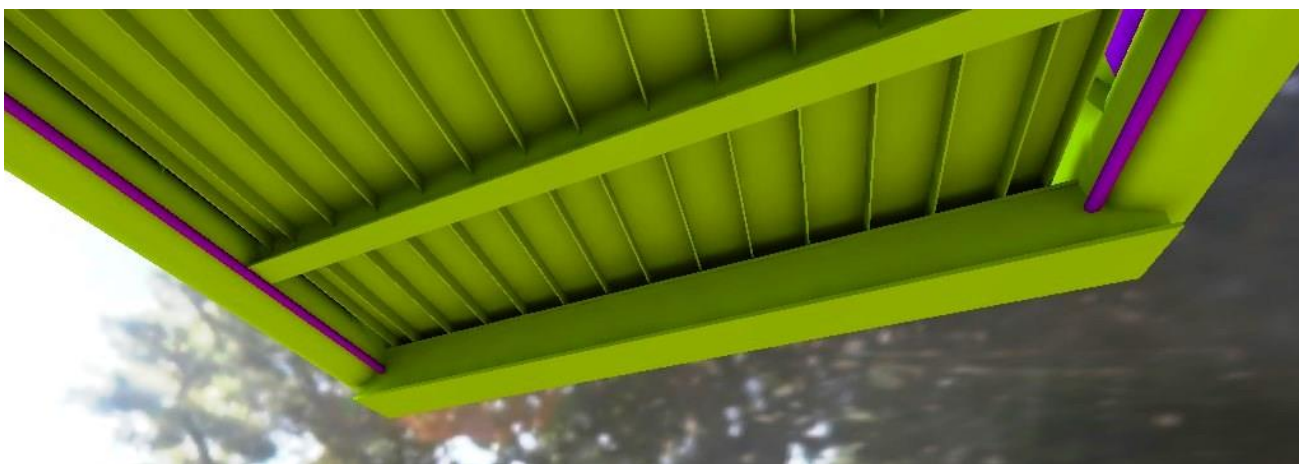
Obr.13 – pohled na poslední masivní příčník (chybí ložiska, opěry atd., vykreslena jen ocelová konstrukce lávky)
